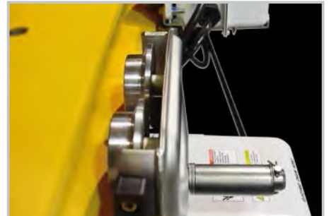
Laufräder beider Fahrwerke aus Edelstahl
